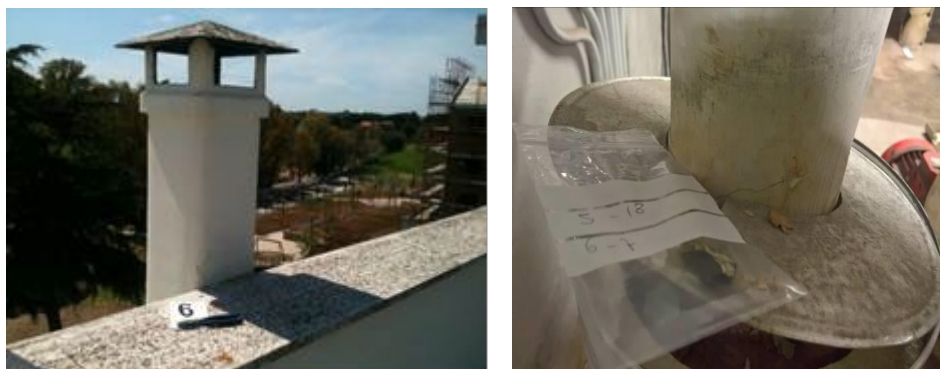
Figure 40 - immagine dei punti di prelievo: canna fumaria (sx) e coibente tubazione (dx)
